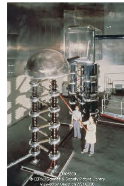
Abbildung 9: Ein im CERN verwendeter Cockroft-Walton-Generator
